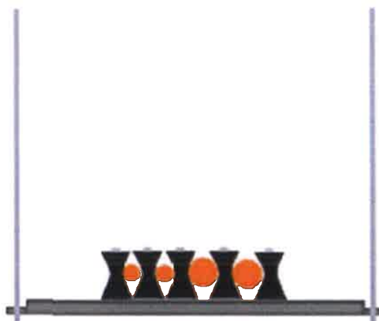
Rysunek 14 Specjalna konstrukcja nośna z profili 400PTTR i dwóch prętów gwintowanych CELO DIN 975 M8 mocowana do stropu. Wykonanie z zastosowaniem obejm Multitub
