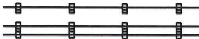
Rysunek 6 Specjalna konstrukcja nośna z uchwytami kablowymi mocowana do stropu, ściany w poziomie 3 lub profilu stalowego oraz blachy stalowej. Wykonanie z zastosowaniem uchwytów F oraz DF
