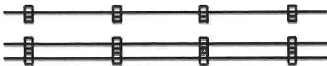
Rysunek 1 Konstrukcja nośna z uchwytemi kablowymi mocowana do stropu, ściany w poziomie 2 lub profilu stalowego. Wykonanie z zastosowaniem uchwytów FT, PFT oraz DFT, PFTX, DFTX
